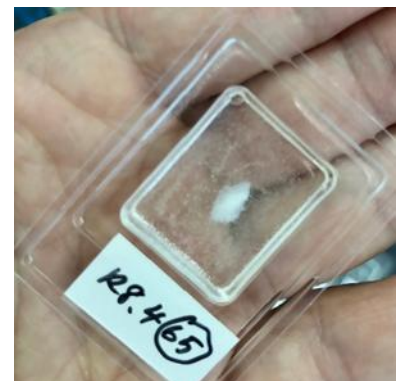
図4：樹脂に包埋した耳石。これを専用の器具でスライスして年齢を見ます。
