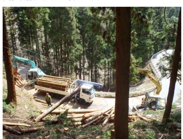
林業機械を組み合わせた効率的な搬出作業
