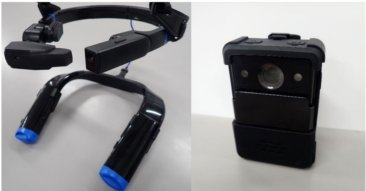
写真1 スマートグラス(左)とウェアラブルカメラ(右)
