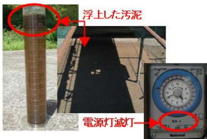
写真5 主電源ダウンによる曝気停止
