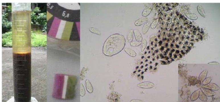
写真4 曝気槽混合液の性状観察（SV、pH、鏡検）
