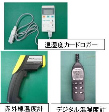
写真3 温湿度管理状況確認に用いたツール
