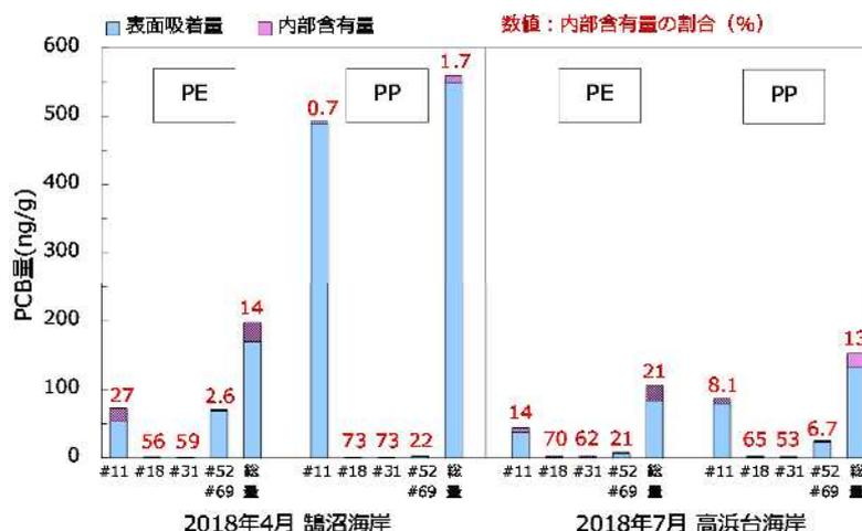
図5.2.2 PCB表面吸着量と内部含有量の比較
