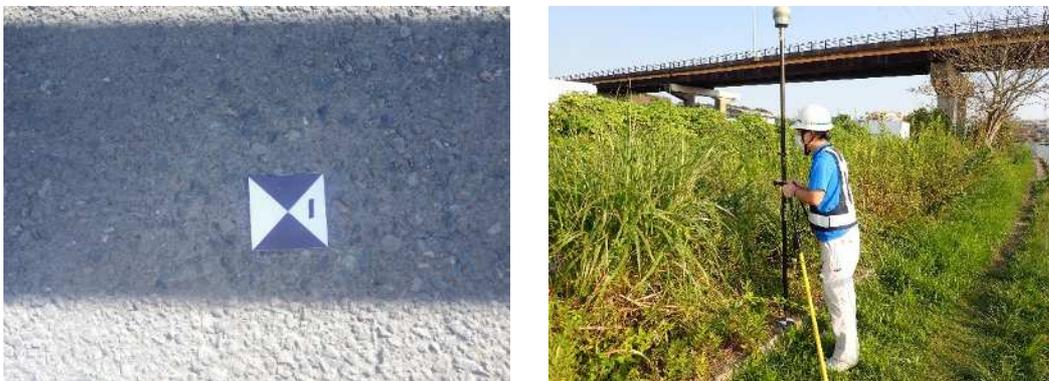
図 3.2.4 標定点測量実施状況 (左図 : 設置した標定点, 右図 : 測量状況)
