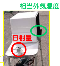
グラウンドでの日射量、相当外気温度の測定
