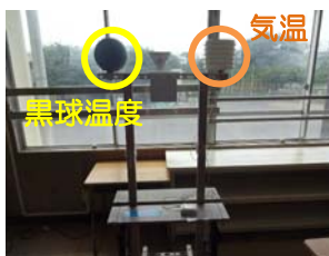
教室内での温度、黒球温度の測定
