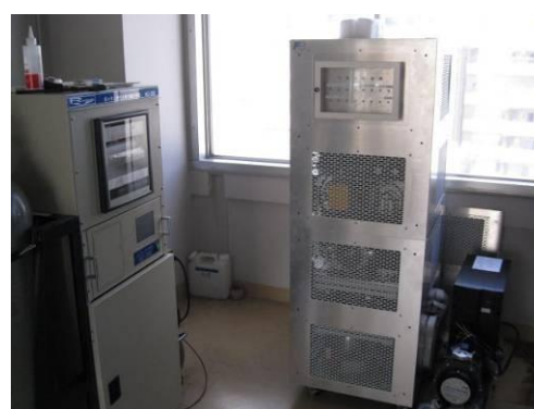
写真5 高津測定局内に設置されたエアロゾル複合分析計
