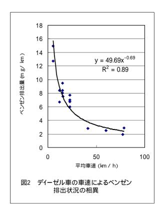
ン排出量は,1.9mg/km~15.0mg/kmの値を示し, ガソリン車のベンゼンの排出量と同様な大きな排 出量は示したが,冷機時の排出量は12.9~15.6mg/kmとガソリン車に比較し少ない値を示した。
