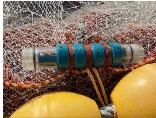
貧酸素水塊の調査 (漁具取付け型の溶存酸素センサー)
