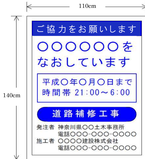
図1-1-2 工事中標示板の標準図
