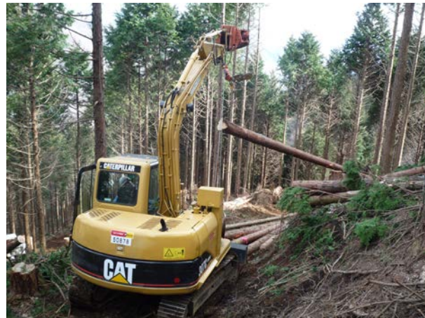
間伐材を林業機械により搬出している状況。
