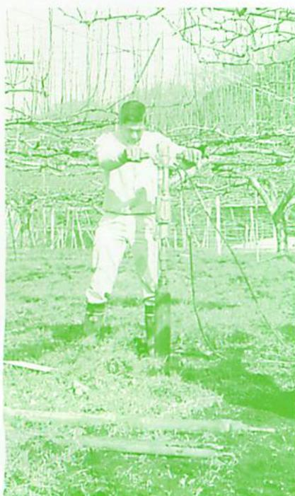
パーカッション採土器は、深層の土壌サンプルを採取するための装置です。太さ約5 cmから15 cmのパイプを、油圧の力を利用して深層まで徐々に叩き込み、最大で5 mの深さまでの土壌サンプルを採取することができます。
