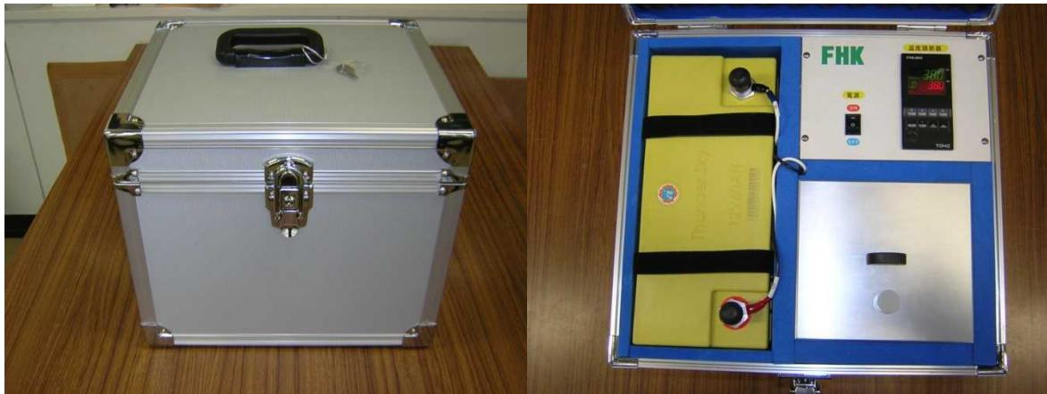
図1. 試作した豚胚専用輸送器
