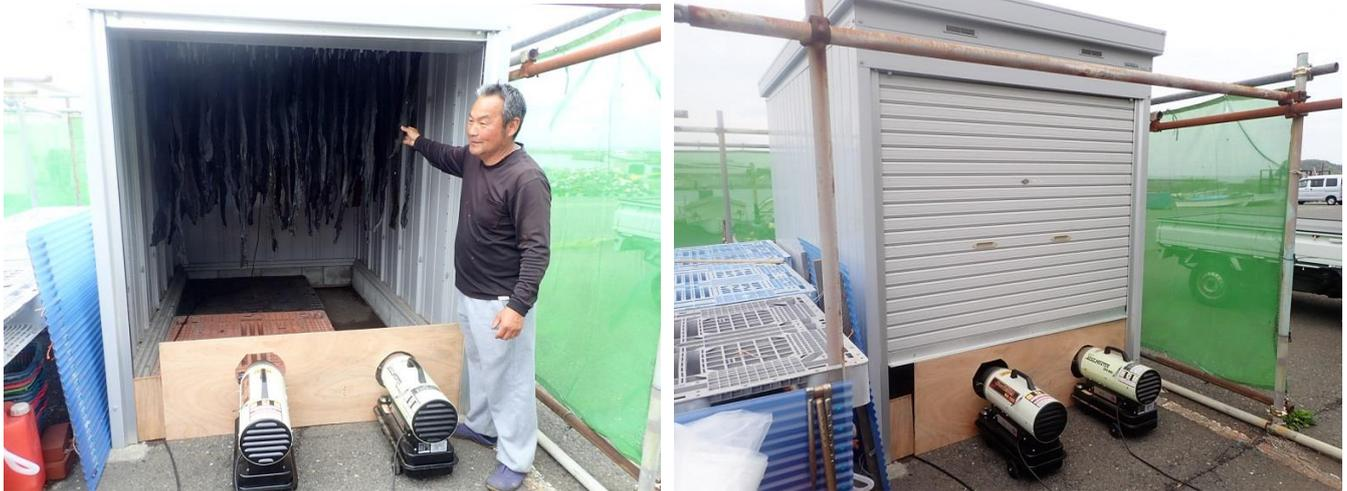
スポットヒーターを用いて乾燥中のコンブ（乾燥中は前面のシャッターを閉めて行う）
