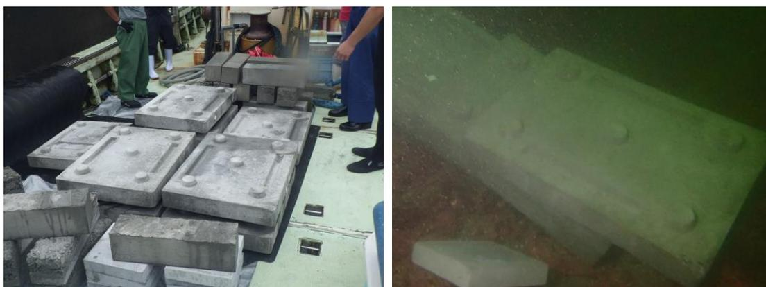
設置するアミノ酸混入コンクリート板等      海底に設置されたアミノ酸混入コンクリート板
