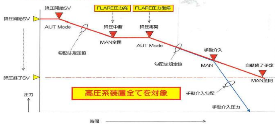
図2 緊急脱圧制御概要
