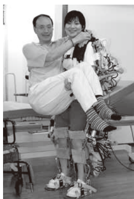
「パワーアシストスーツ」を着用すると女性でも男性を抱き上げることができる
