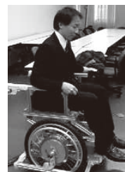
図2 環境適応型 2輪駆動車椅子
