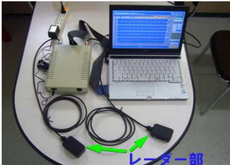
図1 臨床研究に用いたシステム(一次試作機)
