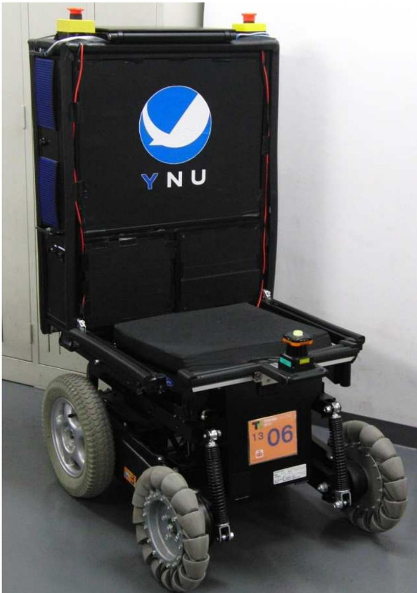
・単一センサー(レーダー距離計)のみから自己位置推定及び地図構築を行う。
