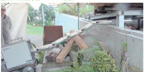
1mの段差を越え、20cmの隙間に進入
