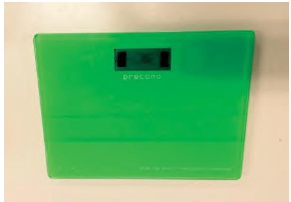
■厚さ10mmの超薄型荷重センサー
