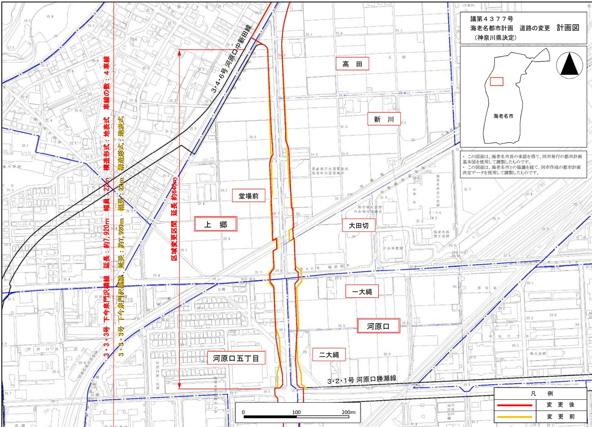
3・3・3号 下今泉門沢橋線 延長：約7,920m 幅員：22m 構造形式：地表式 車線の数：4車線
