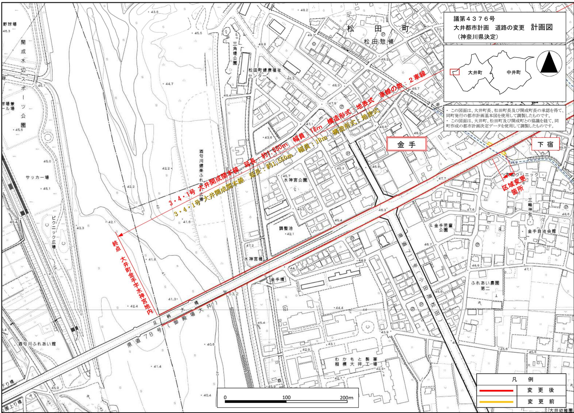
3・4・1号大井開成間本線 延長：約1,550m 幅員：18m 構造形式：地表式 車線の数：2車線
