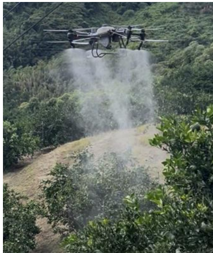
傾斜地に対応したドローンによる農薬散布
