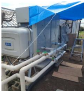
高温対策のためのトマトの培養液冷却装置
