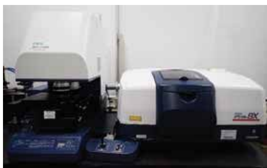
図1：フーリエ変換赤外分光分析システム(日本分光(株)製) 右側：FT/IR-8X(マクロ測定用) 透過、ATR、拡散反射、RAS測定が可能 左側：IRT-7100(赤外顕微鏡) 透過、反射、ATR測定が可能
