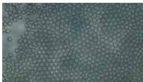
図3：マイクロ流体デバイスにより形成されたドロップレット
