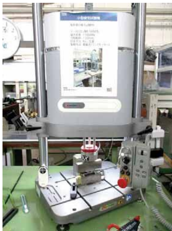
図1：小型疲労試験機
