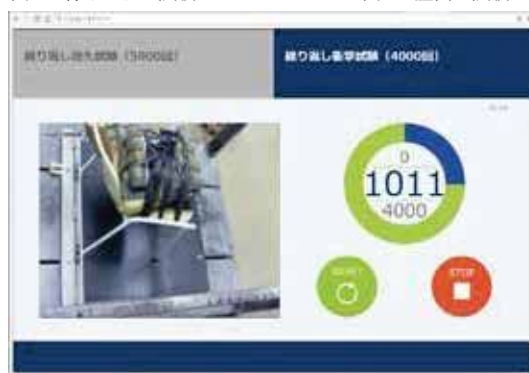
図4：ラズパイを利用したWEBブラウザによる監視画面
