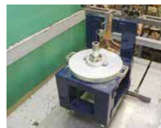
試験用鋼製椅子を使用した試験状況 前脚端部に樹脂製パーツを取り付けてある
