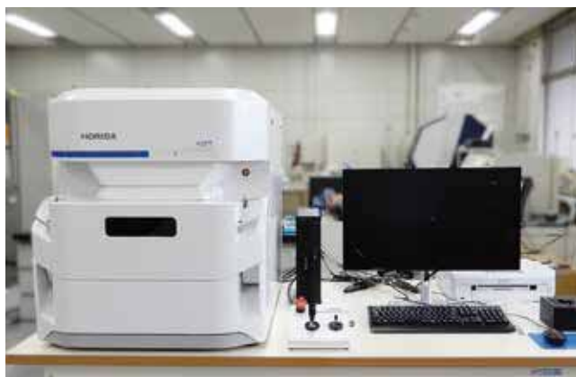
図1：装置外観 (株式会社堀場製作所製、XGT-9000 Expert)
