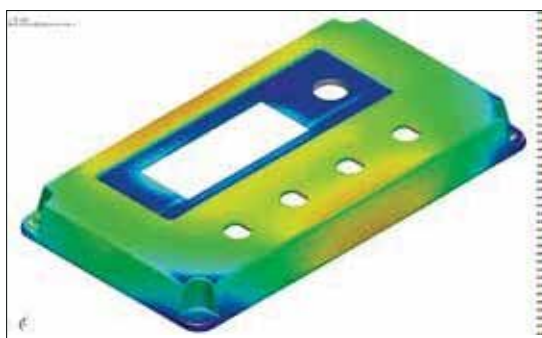
図4：設計データ(図1)と造形結果(図2)の差異
