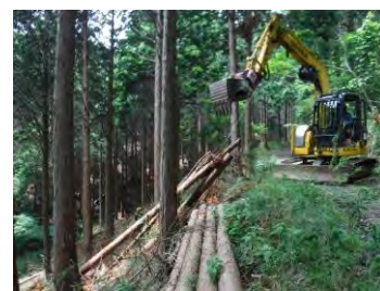
高性能林業機械（ウインチ付きグラップル）を利用した集材作業
