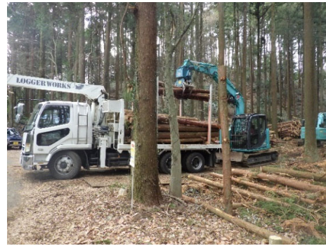
高性能林業機械を用いた間伐材搬出 (厚木市上萩野)
