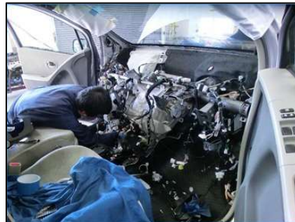
空調装置実習
