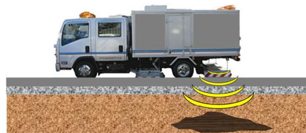
路面下空洞探査車による調査イメージ
