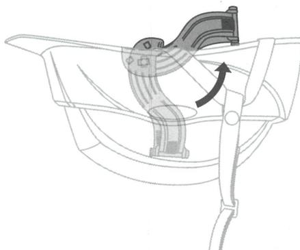
**3** 最後にツメ部A,Bが左右とも正しく差し込まれている事を取り付け図を参照し、ご確認ください。
