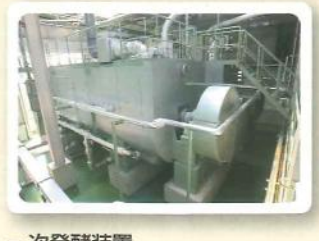
一次発酵装置 下水道汚泥を散気しながら攪拌し、約14日間発酵させます。
