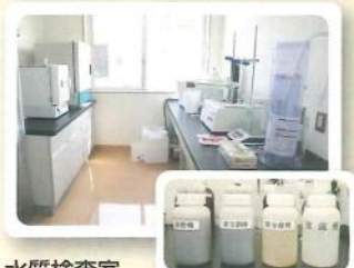
水質検査室 処理水などを分析し、放流基準を満たした安全な水かどうか検査します。
