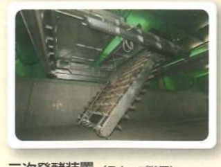
二次発酵装置 (スクープ装置) 脱水汚泥及び一次発酵汚泥を混合し、さらに約14日間発酵させます。
