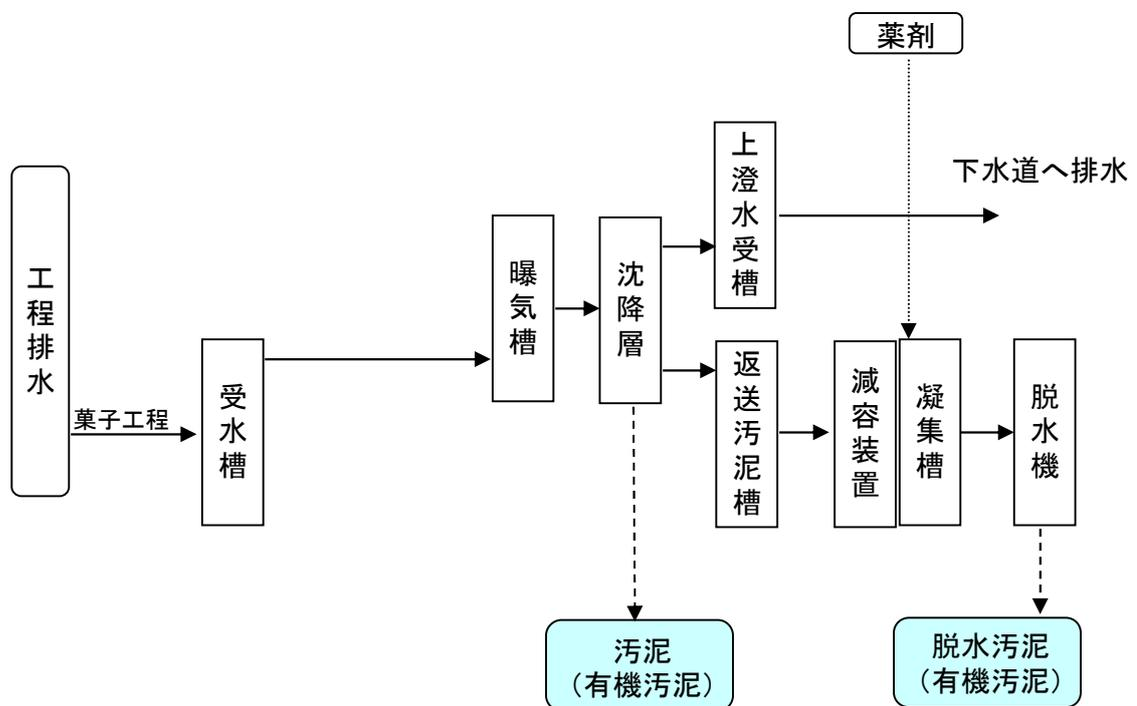
図2 排水処理フローシート[NO.2]
