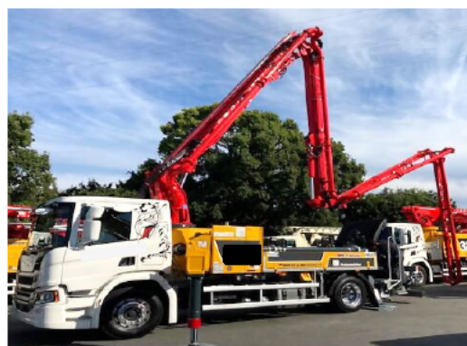
コンクリートポンプ車
