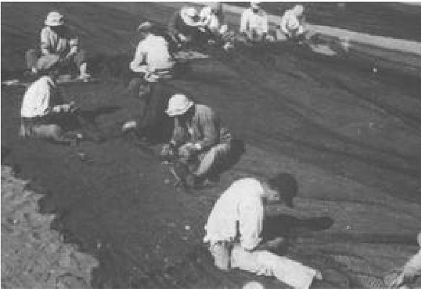
4. 網地の裁断後は、錢口を取付け、各網地を縫い合せる。
