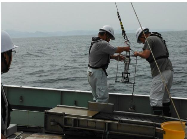
江の島丸は、毎月初めに4～5日ばかりで相模湾から東京湾にかけての41測点で水温・塩分・透明度・溶存酸素量・プランクトン現存量など様々な項目(測点によって項目は異なります)の海洋観測を行っています。観測機器の進歩により、今では水温や塩分は表層から底層まで1m刻みで計測しています。
