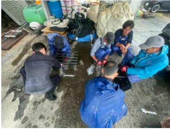
魚礁の組み立て作業
