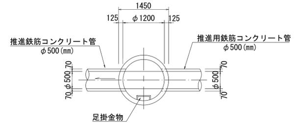
可とう性継手構造図 S=1:50
