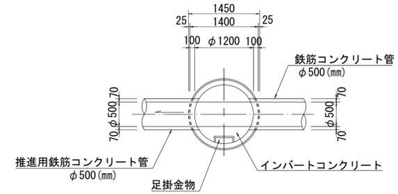
可とう性継手構造図 S=1:50
