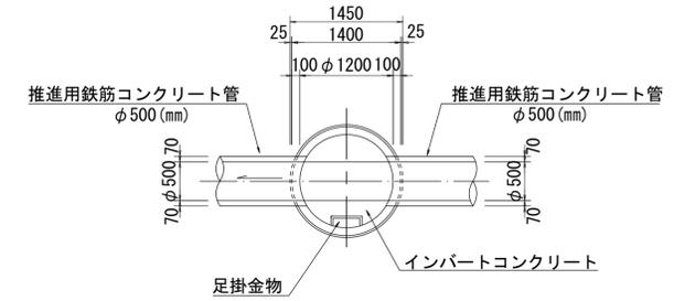
可とう性継手構造図 S=1:50
