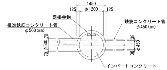
可とう性継手構造図 S=1:50
