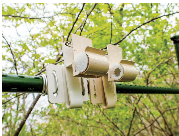
写真7. オゾンの拡散型サンプラー（左）とフラックス捕捉型サンプラー（右） 写真6にあるシェルター（白いカップ）を取り外した状態
