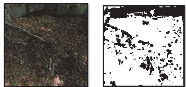
図 3 丹沢山地の堂平地区で撮影した 360 度カラー画像から撮影地点の足元の平面投影カラー画像を切り出した後に緑被部分を二値化処理した結果の例
