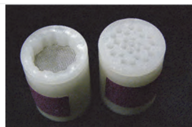
図 2 拡散型パッシブサンプラーの構造（上図）及び拡散型（写真右）と改良型（写真左）パッシブサンプラー
