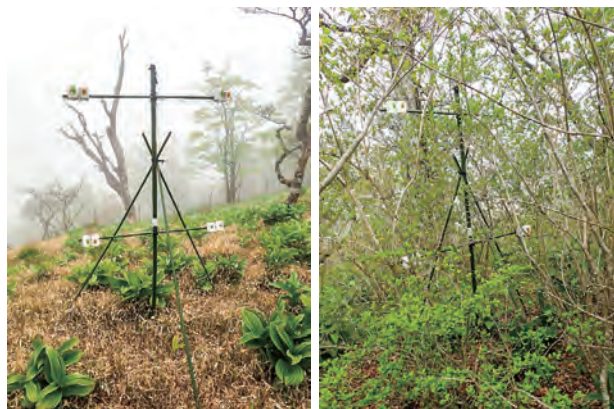
写真6. 檜洞丸のブナ林衰退地（左）および森林更新が進む植生保護柵内（右）でのオゾンパッシブサンプラー観測状況（檜洞丸、2022年5月12日撮影）
