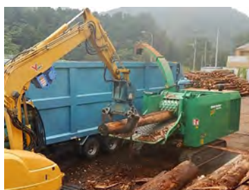
木質バイオマスチップ製造状況 （秦野市菖蒲）
