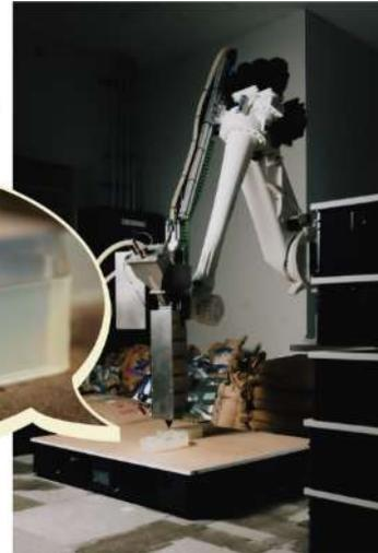
不要なプラスチック製品を「つかうプロダクト」へ生まれ変わらせる、Hamee 株式会社が開発するリサイクルサービス「Parallel Plastics」と連携し、製造過程で発生する端材や型落ちのプラスチック製品を原料として、株式会社 DigitalArchi が開発した建築用大型3Dプリンターを活用して什器や内装を試作する。この取組をもとに、将来的には建設現場の型枠を廃棄プラスチックから製作し、普及させていくことで、廃棄プラスチック問題の解決を目指す。
