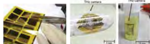
カーボンナノチューブ膜を用いた光画像センサ (大面積シートから切り出し、対象にはり付けて使用可能)
