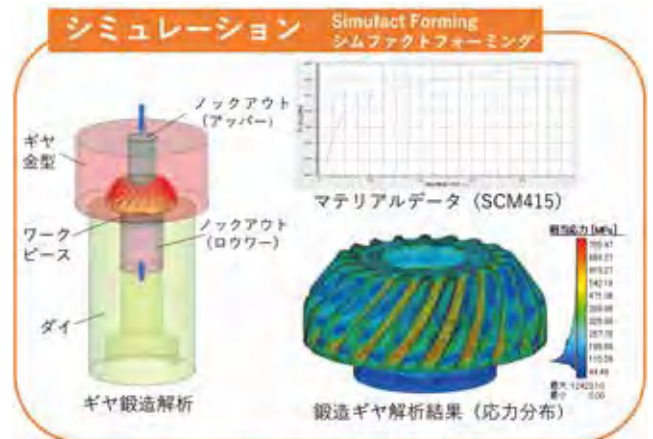
図3 ギヤ鍛造の弾塑性解析シミュレーション
