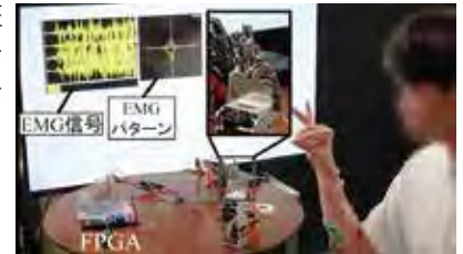
FPGAに実装された「未知を知るAI」によるロボットハンド制御
