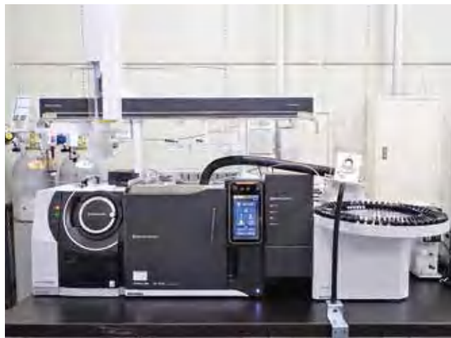
図1 多機能前処理装置付きガスクロマトグラフ質量分析装置
