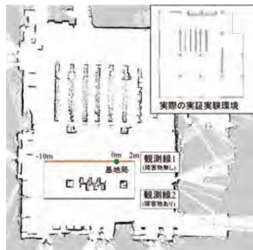
図2 台車ロボットによる実験サイト内のマッピング
