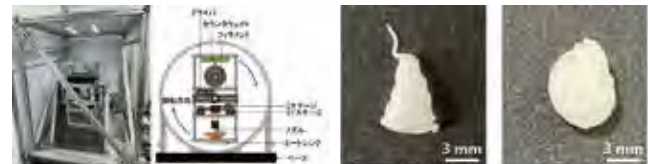
高重力場3Dプリンタの試作装置 1Gにおける堆積物 32Gにおける堆積物
