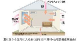
夏に外から室内に入る熱(出典:日本建材・住宅設備産業協会)
