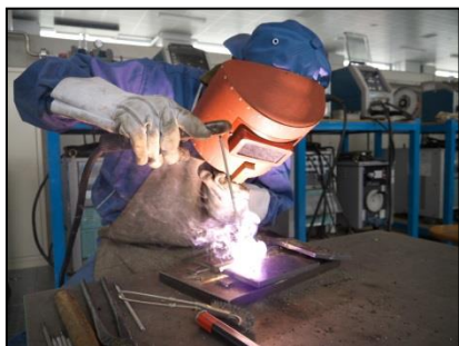
被覆アーク溶接実習
