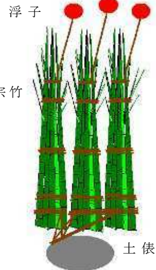
図 7-12 簡易竹魚礁構造図
