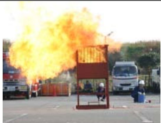
カートリッジ缶の破裂燃焼実験の様子
