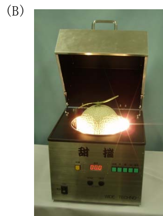
図1 簡易非破壊糖度計の構成(A)と開発した非破壊糖度計「甜揣(てんすい)」(B)
